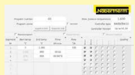
Input di processo tramite il software NTEdit (freeware) per MS Windows™
