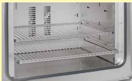
Griglie estraibili per il caricamento dell'essiccatore ad armadio a vari livelli
