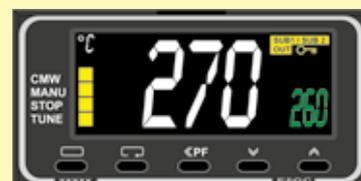
Esempio di limitatore di sovra temperatura
