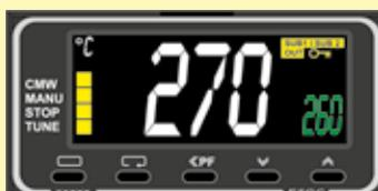
Esempio di limitatore di sovra temperatura
