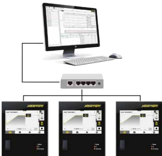
Esempio di configurazione con 3 forni
