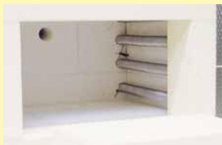
Vano forno con isolamento resistente in mattoni refrattari leggeri
