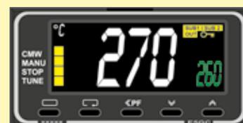
Esempio di limitatore di sovra temperatura
