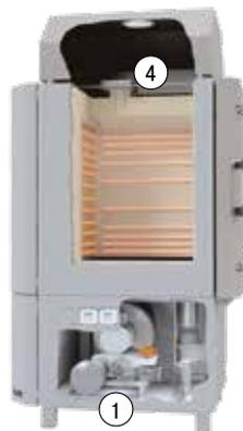
Sinterizzazione: Sinterizzazione senza alimentazione dell'aria fresca tramite la ventola dell'aria fresca (1) e valvola di scarico dell'aria (4) chiusa
