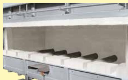
Riscaldamento indiretto a gas con tubi radianti
