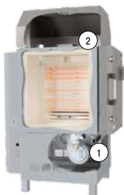
Sinterizzazione: Sinterizzazione senza alimentazione dell'aria fresca tramite la ventola dell'aria fresca (1) e valvola di scarico dell'aria (2) chiusa
