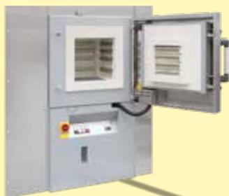
Forno a camera LH 30/12S DB50 in esecuzione per camera bianca
