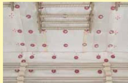
Copertura in tessuto della coperta in fibre (e lati) per ridurre le polveri di fibre
