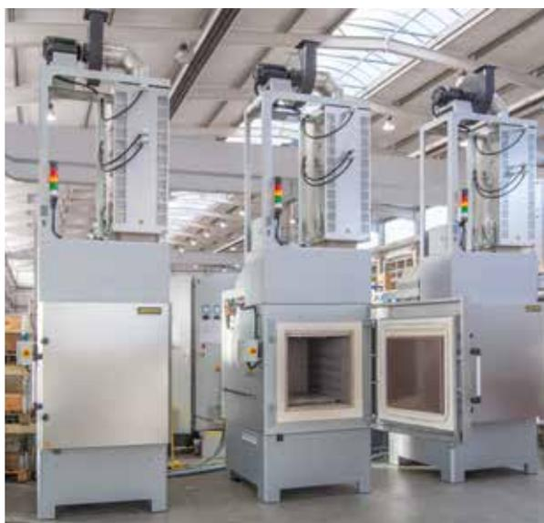
Impianto di produzione con tre forni a camera a convezione NA 250/85 DB200 per il deceraggio e la post-combustione catalitica KNV 320 (struttura con superficie di installazione ridotta)
