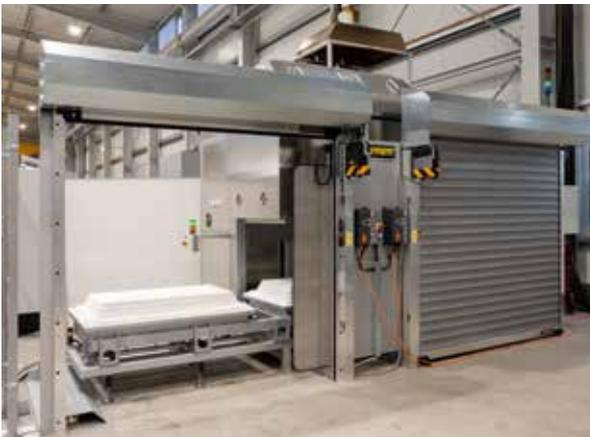
Forno ad alta temperatura-a campana HT 400/17 LT DB200-4 con serrande avvolgibili per il cambio tavolo automatico
