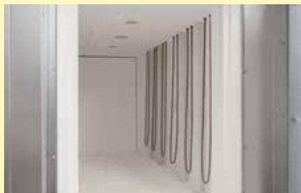
Soffiaggio di aria fresca preriscaldata tramite tubazioni perforate in ceramica
