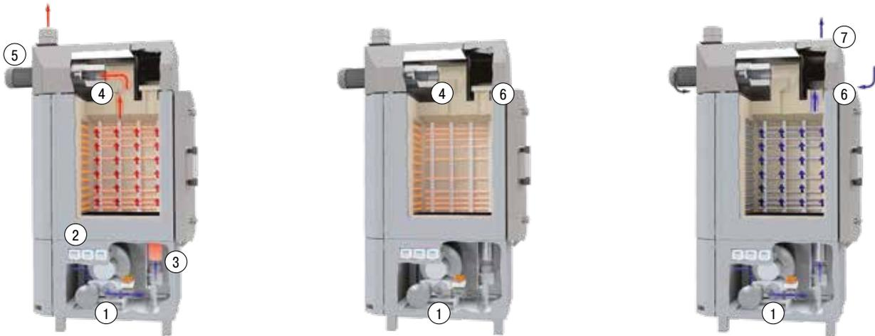
**Deceraggio:** Alimentazione della quantità necessaria di aria fresca tramite la ventola dell'aria fresca (1), e controllo della quantità di aria fresca e di gas di scarico nonché della pressione del forno (2), preriscaldamento dell'aria fresca tramite riscaldatori dell'aria fresca (3), espulsione dei gas di scarico tramite la valvola di scarico dei gas (4) con ventola di scarico dell'aria (5)
