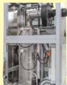
Post-combustione catalitica per la pulizia dell'aria di scarico (dotazione aggiuntiva)
