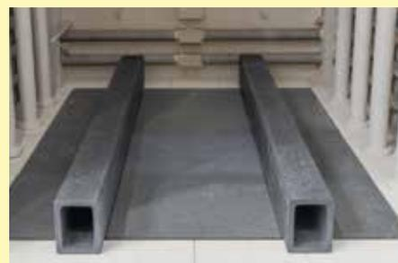
Piano di caricamento SiC per il carico/scarico facilitato mediante carrello elevatore
