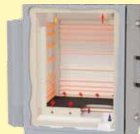
Illustrazione schematica della conduzione dell'aria nel forno a camera N(B) .. BO
