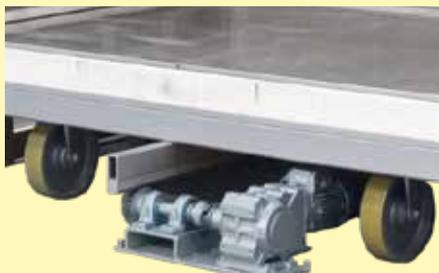
Carrello su ruote di alluminio senza spostamento delle rotaie e con azionamento a cremagliera
