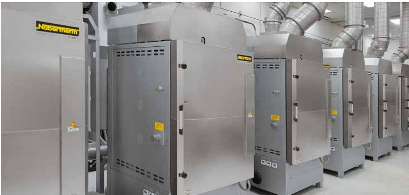
Impianto di produzione composto da forni a camera combinati N 650 DB200 con post-combustione catalitica per funzionamento alternato
