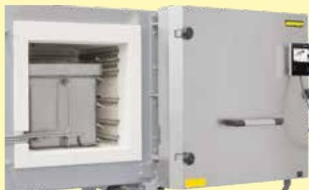
Porta ad apertura parallela per aprire il forno da caldo
