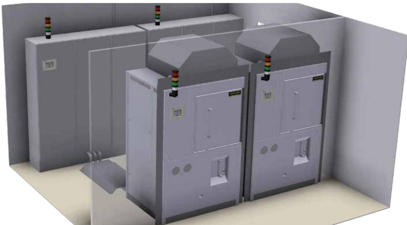
Forni ad alta temperatura con caricamento dalla camera bianca; impianto di distribuzione e forno installati in camera grigia
