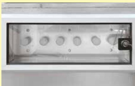
Gasaggio regolabile per aria asciutta e pulita (CDA). Bloccabile per aumentare la sicurezza di processo
