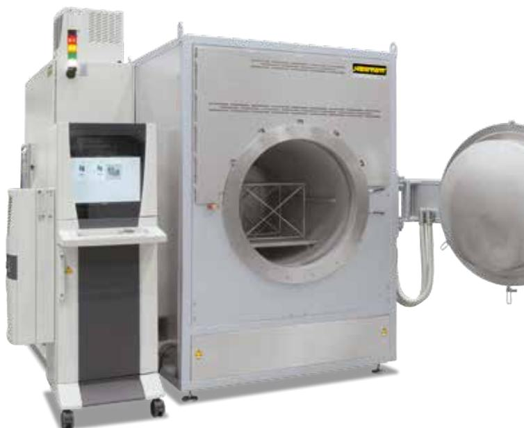
Forno a storte NR 300/08 per il trattamento in alto vuoto con NCC in un armadio separato
