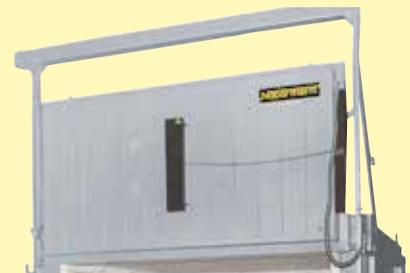
Porta ad apertura parallela ad azionamento elettro-idraulico
