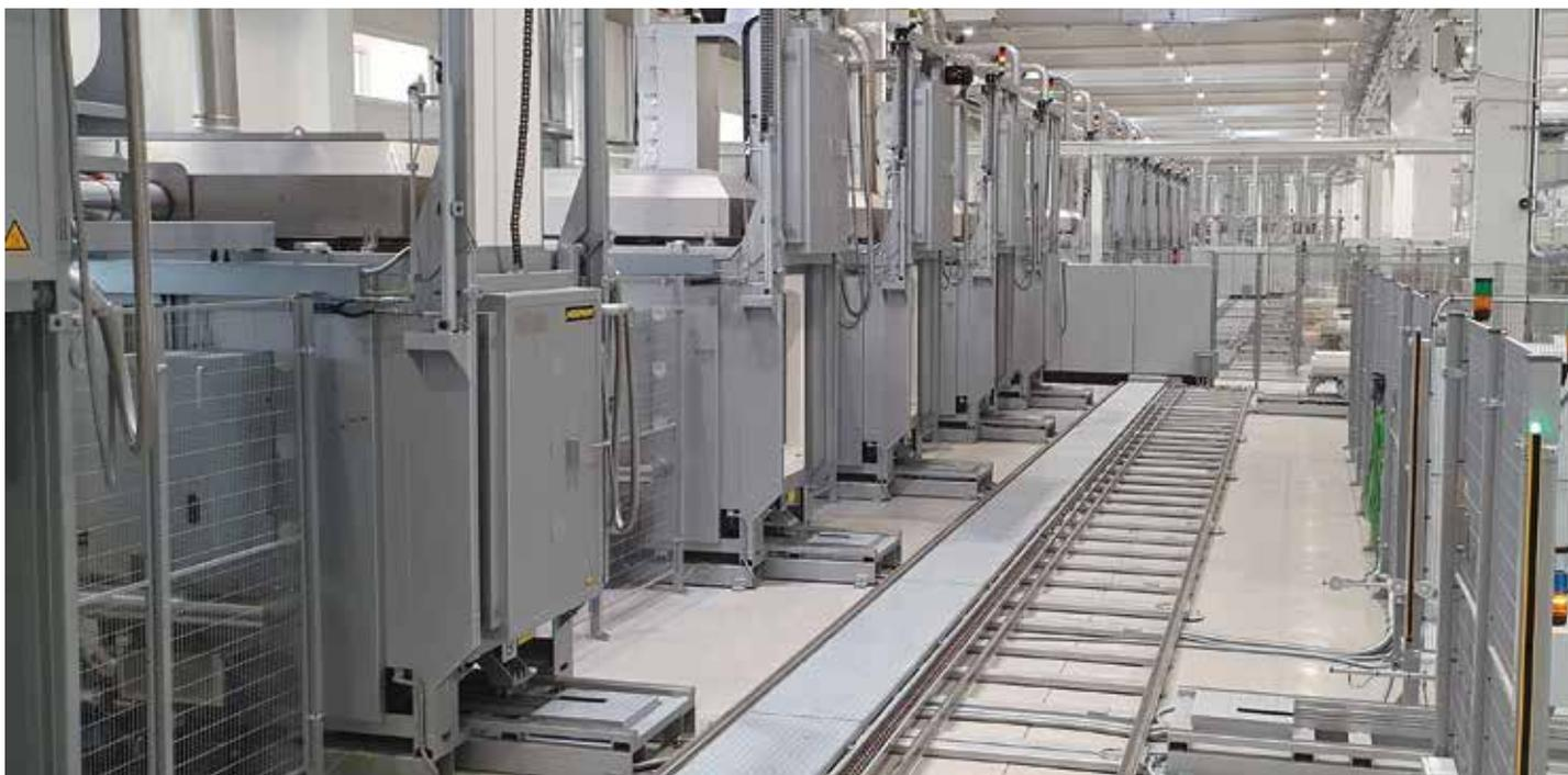
Impianto con sei forni combinati a suola mobile W 2254/14 DB200-3 con post-combustione catalitica per l'esercizio alternato, porta a ghigliottina e sistema di trasferimento con stazione di carico/scarico per l'esercizio automatico
