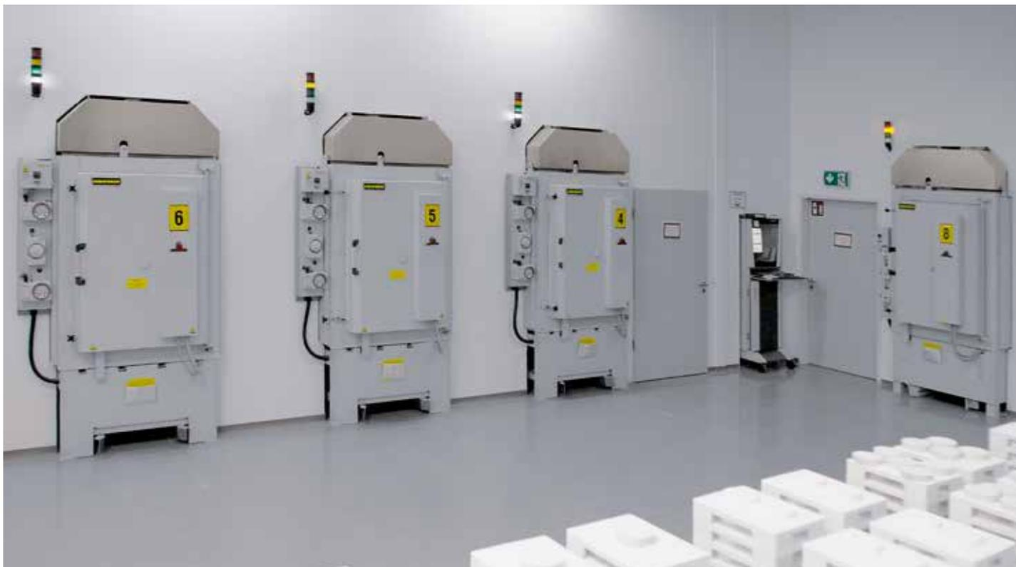
Forni a camera combinati N 650 DB 200-3 per il deceraggio e la sinterizzazione in camera bianca/camera grigia
