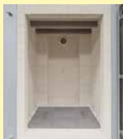
Camera del forno NB 650 BO con riscaldamento del forno a gas
