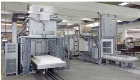
Forno ad alta temperatura-a campana HT 1700/17 LT DB200-5 per il deceraggio e la sinterizzazione di polveri ceramiche
