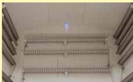
Camera del forno N 300 BO con fiamma di accensione a gas e riscaldamento del forno elettrico
