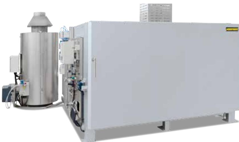
Forno a camera a convezione NA 4000/60B DB200 per il deceraggio in aria con post-combustione termica a gas TNV 300
