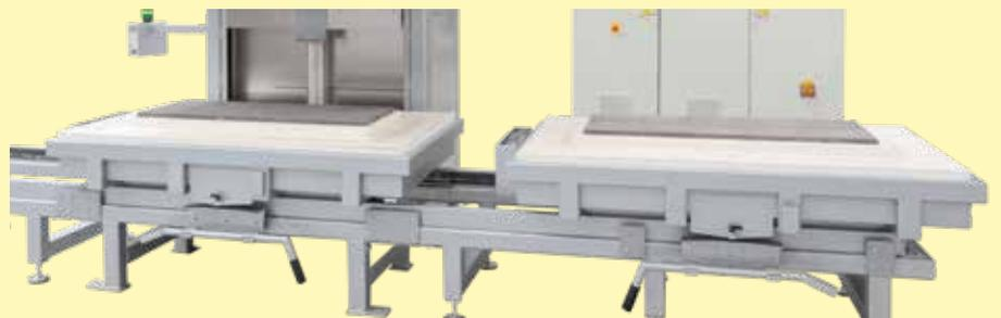
Sistema manuale di cambio tavolo per due tavoli per il carico e lo scarico paralleli della carica durante il ciclo
