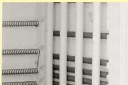
Immissione di aria preriscaldata attraverso tubi in ceramica perforati
