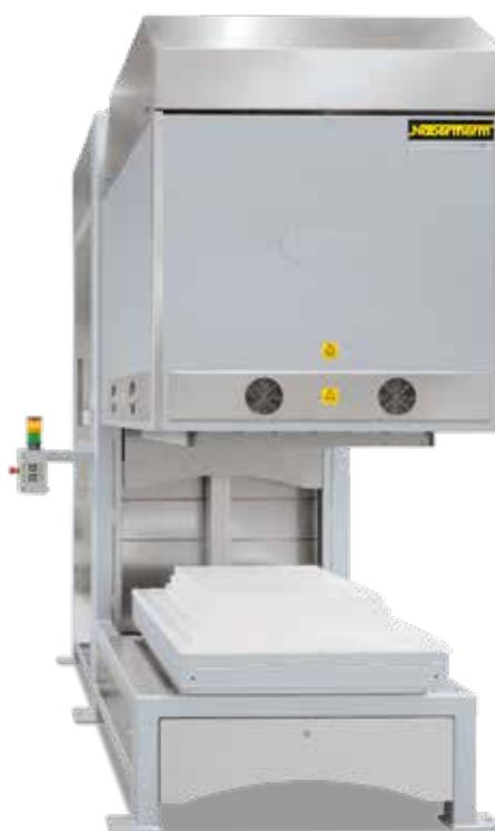
Forno ad alta temperatura-a campana HT 230/17 LT con campana motorizzata
