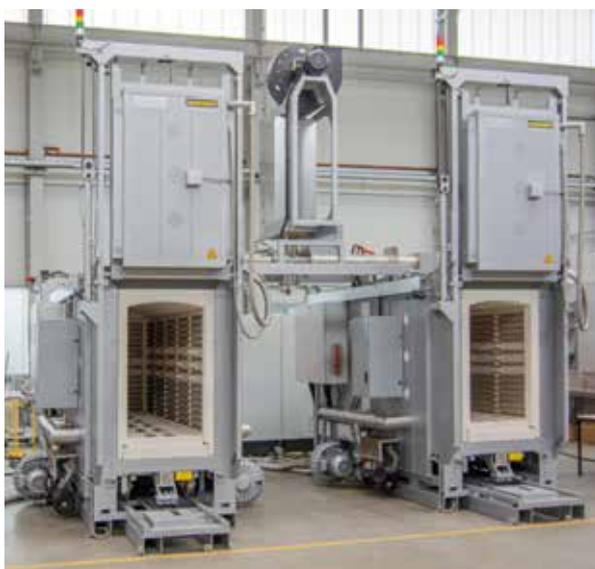
Due forni a suola mobile W 2254/14 DB200-4 con post-combustione catalitica per l'esercizio alternato
