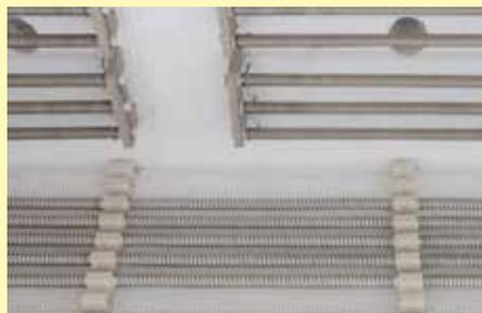
Isolamento in fibra per tempi di riscaldamento e raffreddamento ridotti
