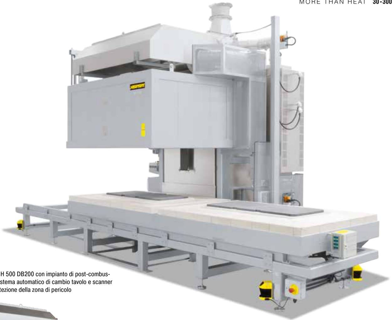
Forno a campana H 500 DB200 con impianto di post-combustione catalitica, sistema automatico di cambio tavolo e scanner di sicurezza a protezione della zona di pericolo
