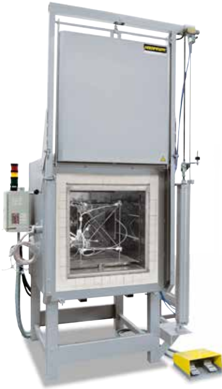
Messgestell zur Ermittlung der Temperaturngleichmäßigkeit
