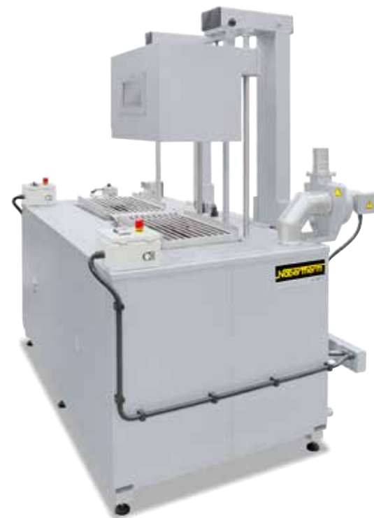
Kombiniertes Öl-Abschreck- und Reinigungsbad mit absenkbarren Tischen, Schutzhaube, Ölabscheider und Absaugung
