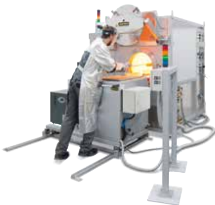
Halbautomatische Vergüteanlage mit Retortenofen NR 50/11 und Wasserabschreckbad auf einem Schienensystem
