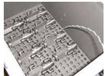
Hartlöten im Begasungskasten
