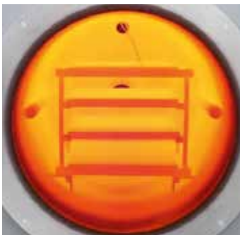
NR 50/11 mit Chargiergestell für die manuelle Entnahme bei hohen Temperaturen für das Abschrecken im externen Bad
