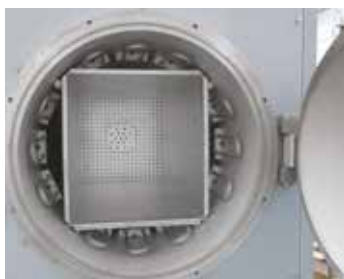
Innenbeheizung Retortenofen NRA ../06
