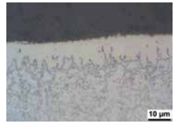
Detailaufnahme eines metallografischen Schliffes eines im Pulver borierten Warmarbeitsstahls
