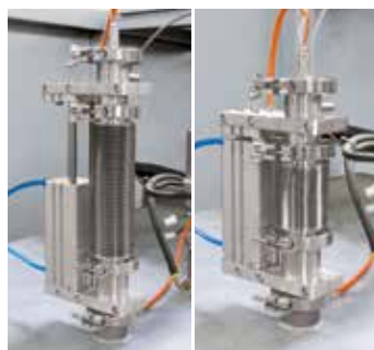
Thermoelement, Typ S mit automatischer Herausziehvorrichtung für sehr gute Regelergebnisse im unteren Temperaturbereich
