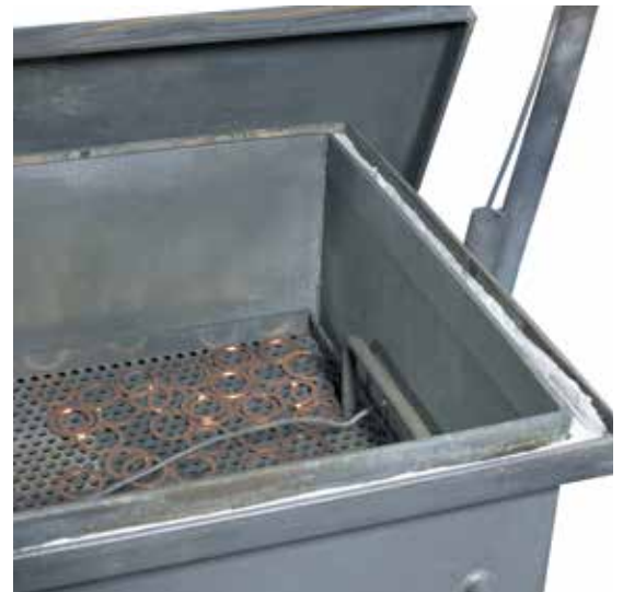
Wärmebehandlung im Begasungskasten unter Schutzgasatmosphäre mit Chargethermoelement
