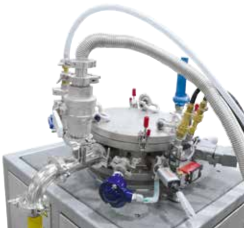
Retorte mit Vakuum- und Schutzgasleitung, Kühlwasseranschlüssen sowie Thermoelementen und Drucksensoren
