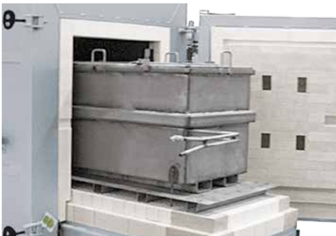
Schutzgaskasten für den Einsatz in einem Herdwagenofen
