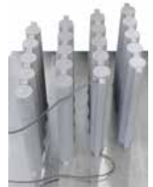
Zugstäbe aus Titan nach der Wärmebehandlung im NR 50/11 unter Argonatmosphäre
