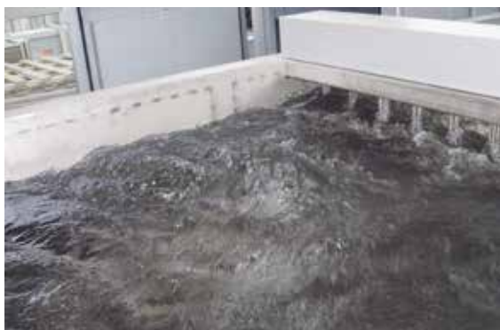
Leistungsstarke Umwälzung des Abschreckmediums
