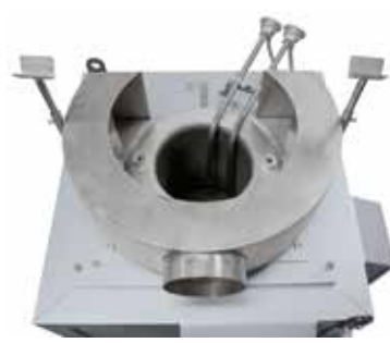
TS 30/18带有两个盐浴热电偶的型用于铝的热处理
