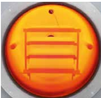
NR 50/11型连同在高温下人工取出时用的装料架，用于在外部池中进行淬火
