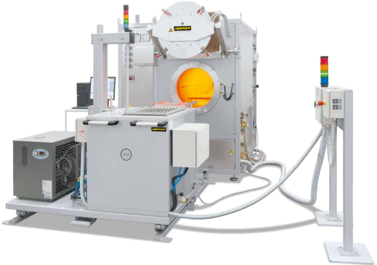
半自动调质设备，带NR 50/11型罐式炉和在一个轨道系统上的淬火水池
