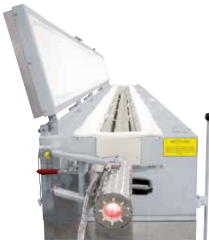
钢丝退火拉伸炉以管式炉为基础，长度为6米
