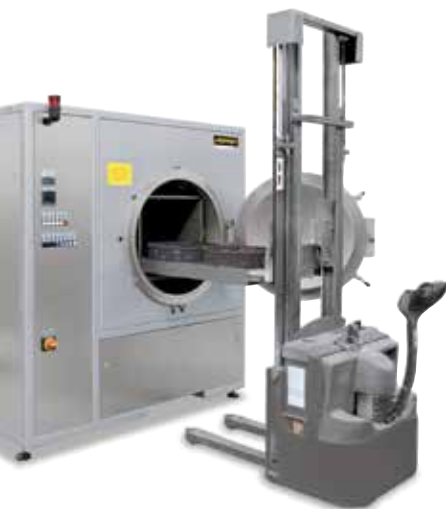
通过升降叉车给NRA 300/06型罐式炉装料
