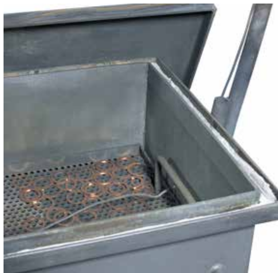
在带有炉料热电偶的供气盒中的保护气体气氛下进行热处理
