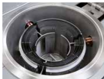
带钨丝加热装置的圆柱形气密罐
