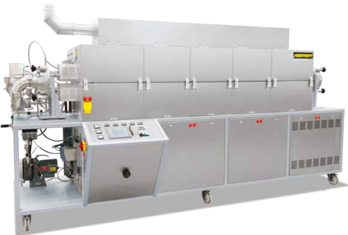
RS 250/2500/11S，五区控温，用于在高真空或保护气氛下的线圈退火，包含强制冷却和废气收集罩
