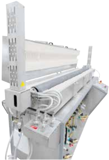
基于罐式炉的钢丝退火拉伸炉连同安全包，用于作为工艺气体的氢气
