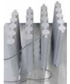
用NR 50/11型窑炉在氩气气氛中进行热处理后的钛拉伸棒
