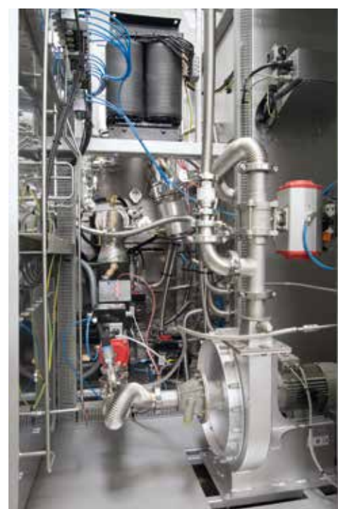
VHT 8/16-MO型冷壁罐式炉的气体快速冷却
