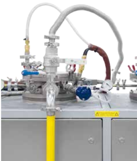
带有供气 and 测量管道的替换式炉罐
