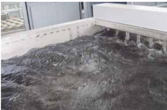
性能强大的淬火媒质循环装置
