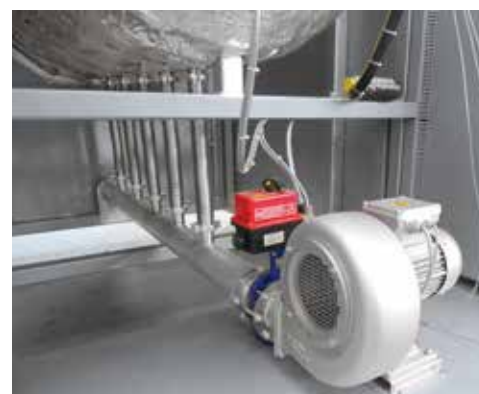
NRA 400/03型热壁罐式炉的鼓风机冷却
