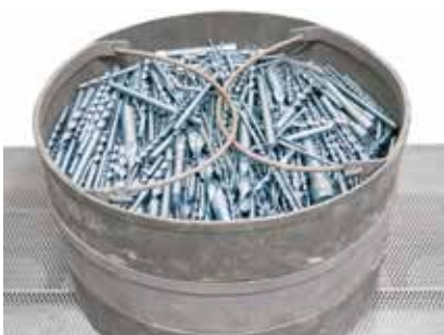
采用水蒸气在一个NRA系列的炉内对钻头进行 蓝化处理见第16页
