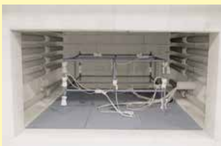
退火炉内的测量装置
