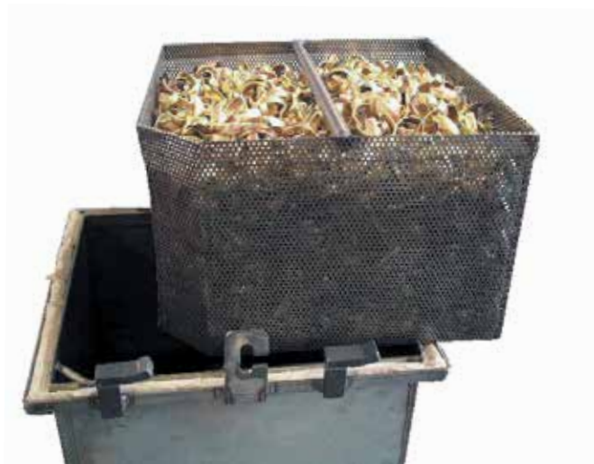
配有抽气装置的退火盒内的散件光亮退火
