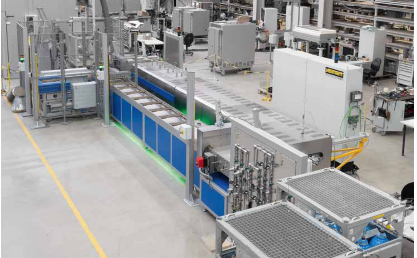
连续加热炉设备D 520/2600/55-04 S用于在保护气体环境下烧结特氟龙涂层
