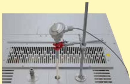
安装在顶盖内的热电偶套管，带支架
