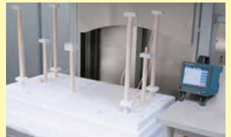
用于确定高温升降底座炉温度分配的测量装置
