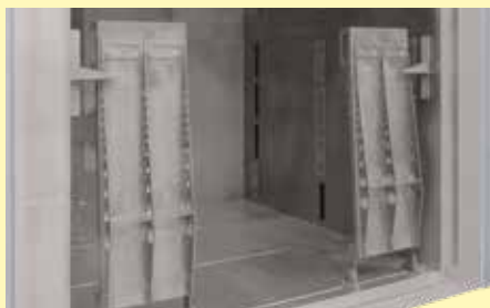
用于对温度均匀性要求较高的工艺，在带有底部绝缘层的窑炉上的驶入通道
