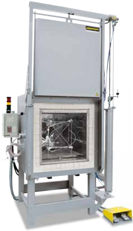
用来测量温度均匀性的测量架
