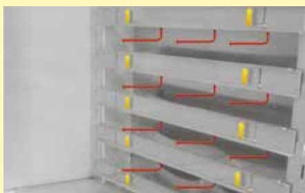
进气百叶窗板可调，用于调整吹向物料的空气的导向
