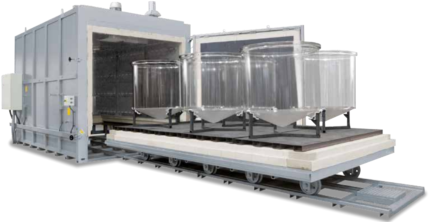
W 19150/60AS型循环空气台车炉，用来消除硼硅玻璃毛坯件的应力
