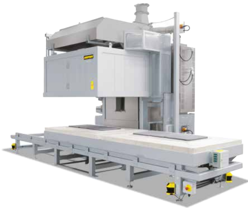
H 500 DB200型顶罩炉带催化后燃烧系统，自动工作台转换系统以及用于保护危险区域的安全扫描仪
