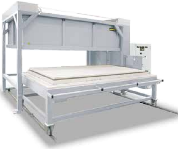
HG1196/S炉设备，客户化的结构设计，炉罩和工作台均可加热；工作台加热元件可在热熔加工时关闭
