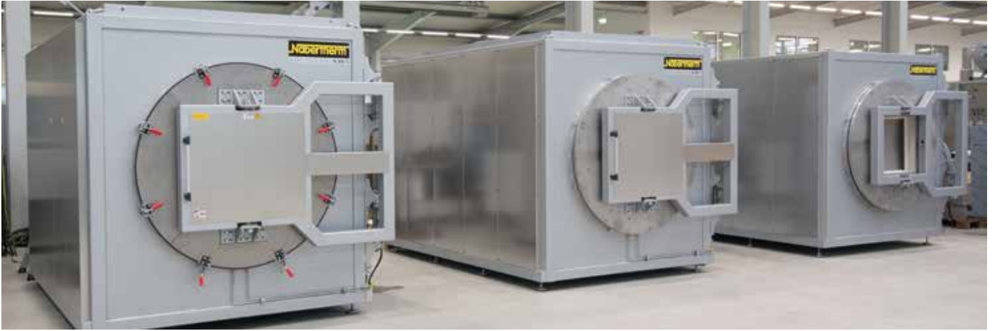
NR 1000/11型热壁罐式炉生产中的
