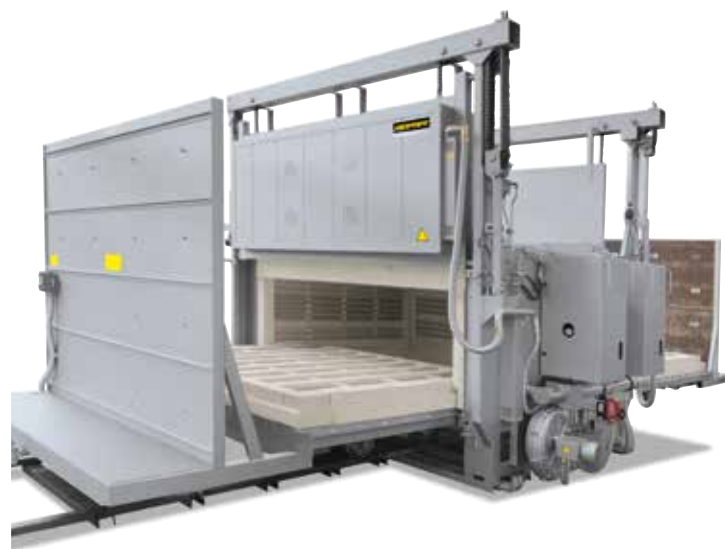
带隔热罩的台车炉 W 2394/S
