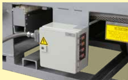
采用接插连接的装料热电偶接口
