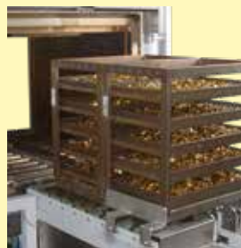
用于盘装散料热处理的连续炉
