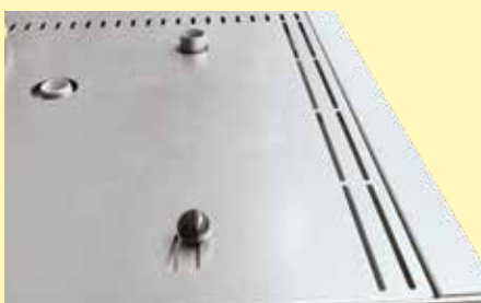
炉顶上的可调节排气口
