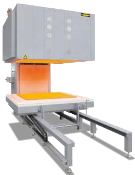
底部升降炉H 1600/S用于石英玻璃的热处理。窑炉采用适合在1000℃下打开的设计。台架可拉出，用于加工部件。
