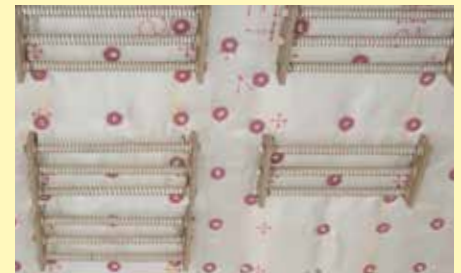
采用织物布料遮盖纤维隔热装置，以减少炉内的粉尘负载
